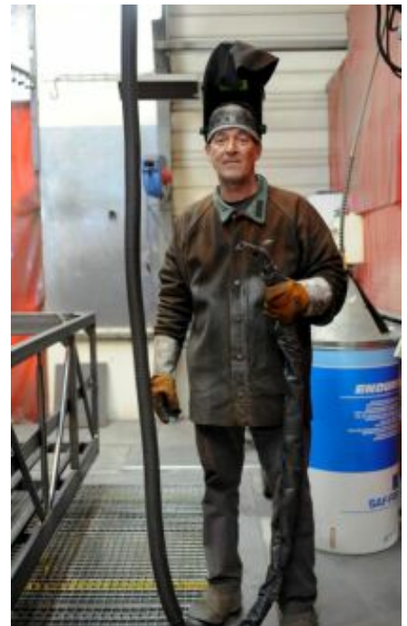
Soudeur tenant une torche aspirante et portant des équipements de protection individuelle
